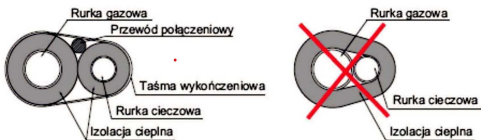
Rysunek 1 Sposób izolowania rurociągów
